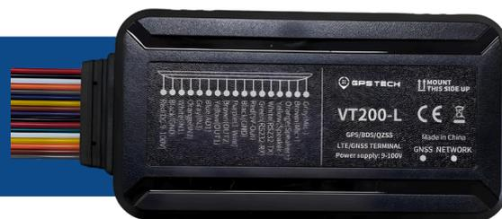
VT200-L dispositivo de geolocalización de vehículos GPS con conectividad 4G, monitoreo de vehículos en tiempo real, antirrobo, gestión de flotas y conexiones de entrada y salida de información
